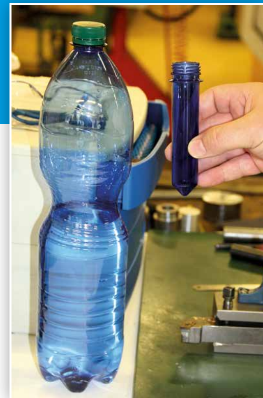
Vorher / Nachher – So sieht eine PET-Flasche vor Ihrer Formgebung aus. Die Drehverschlusskappe wäre bereits aufschraubbar.
